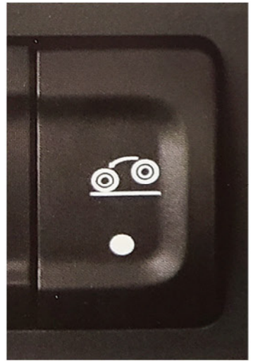
트랙션 헬퍼기능 6x2 트랙터 구동축에 하중을 부여하여 미끄러운 노면으로부터 탈출 용이
